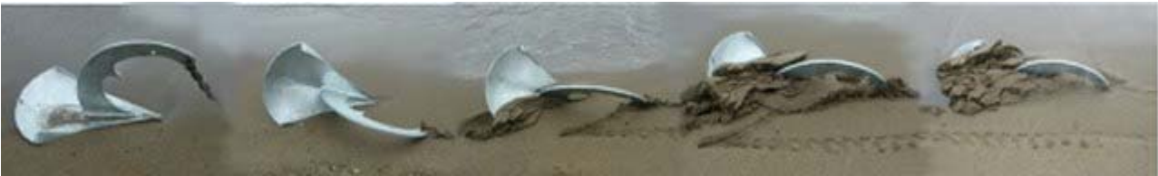
Phases d'enfouissement d'une ancre Océane
