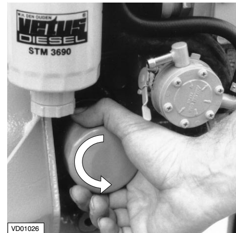
Oliefilter demonteren
