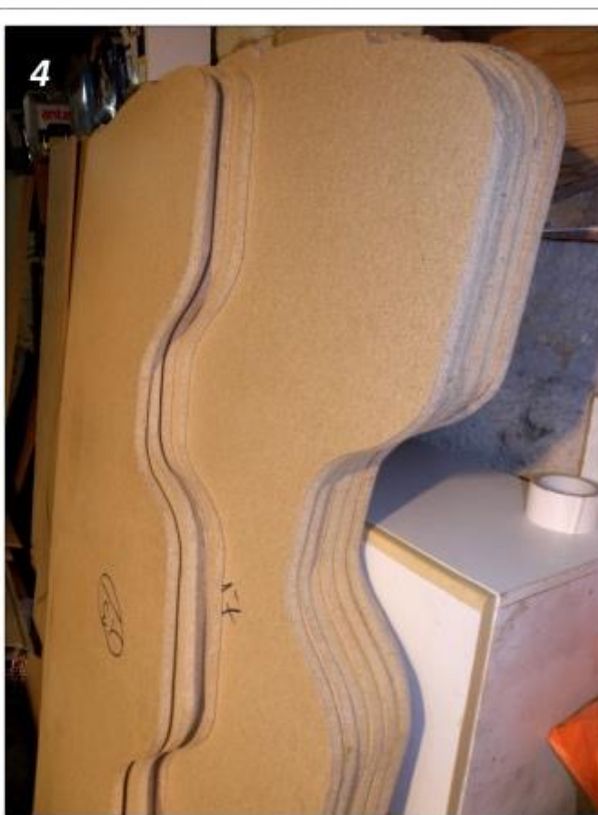
Découpe des couples dans l'agflo
